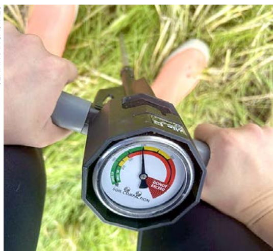
Penetrometrissa eri värialueet kertovat maan tiivyyden voimakkuudesta.
