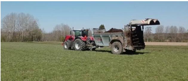
Kuva 1. Kuivalantalevitin suomalaisella pilottitilalla. Kuva: Anna Okkonen
