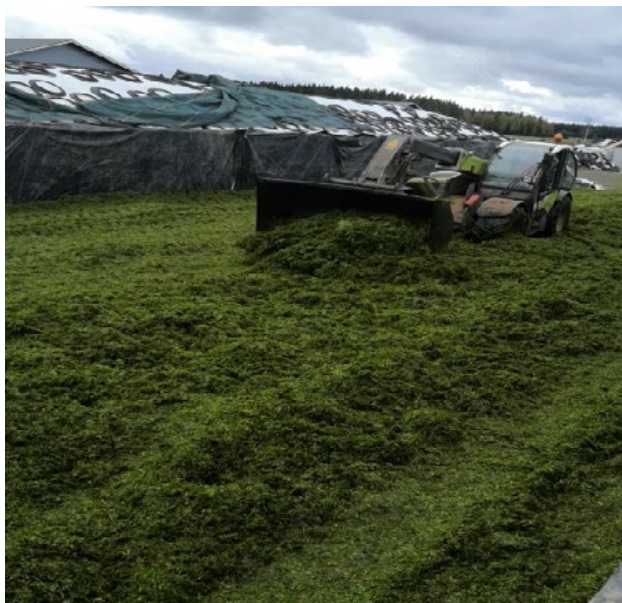
Kuva 9. Kurottajan kauhan tilalle suositeltiin vaihdettavaksi talikkopää paremman tiivistymisen varmistamiseksi.
