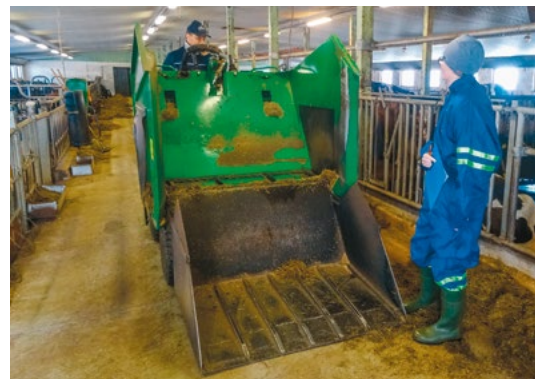
Hannu Tolonen on muuttanut kahteen suuntaan jakavan rehunjakovaunun seosrehulle sopivaksi. Työtä seuraamassa ProAgria Kainuun Minna Tanner.
